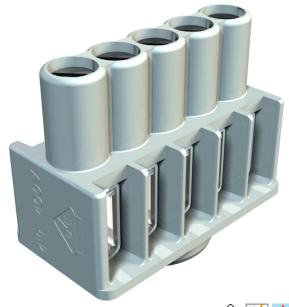
Klemmkörper und Schrauben aus Stahl, galvanisch verzinkt und transparent passiviert, Nennquerschnitt  $1 \div 4$  mm², Nennspannung 400 V, 5-polig, mit Buchsenklemmen max. anschließbare Querschnitte je Klemmstelle max.  $4x2,5mm^2,5x1,5mm^2$  oder  $6x1mm^2$ .
