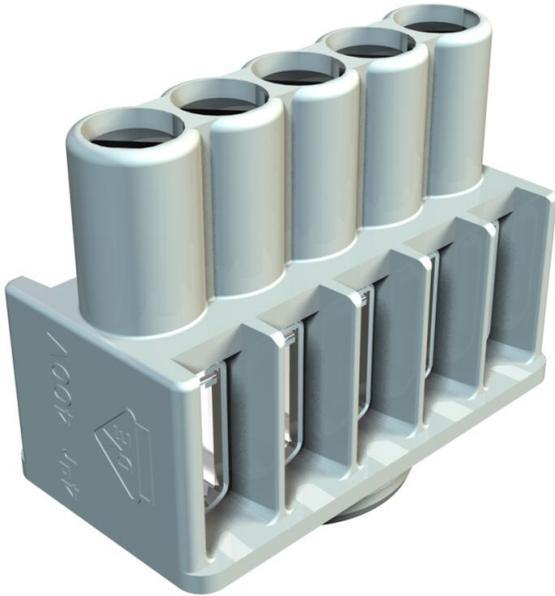
Bornes et vis en acier, galvanisées (passivation transparente), section nominale 1 ÷ 4 mm<sup>2</sup>, tension nominale 400 V, à 5 pôles, avec bornes à douilles, sections de raccordement maximales par point de raccordement : max. 4x2,5mm<sup>2</sup>, 5x1,5mm<sup>2</sup> ou 6x1 mm<sup>2</sup>.
