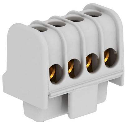
Morsetti in ottone, viti in acciaio, zincati galvanicamente e passivati trasparenti, sezione nominale 6 ÷ 16 mm<sup>2</sup>, tensione nominale 400 V, a 1 polo, con morsetti prese max. collegabili per cavo per punto di bloccaggio: max. 4 x 16 mm<sup>2</sup>, 4 x 10 mm<sup>2</sup>, 8x6 mm<sup>2</sup> o 12x4 mm<sup>2</sup>.
