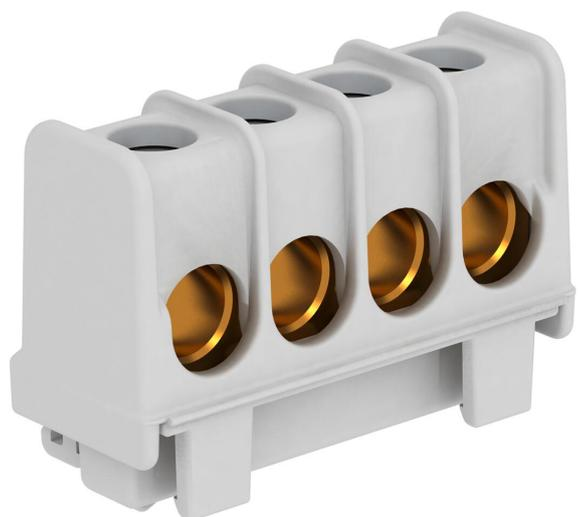
Morsetti in ottone, viti in acciaio, zincati galvanicamente e passivati trasparenti, sezione nominale 16 ÷ 35 mm<sup>2</sup>, tensione nominale 400 V, a 1 polo, con morsetti prese max. collegabili per cavo per punto di bloccaggio: max. 4 x 35 mm<sup>2</sup>, 4 x 25 mm<sup>2</sup>, 8x16 mm<sup>2</sup> o 12x10 mm<sup>2</sup>.
