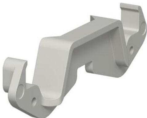
Graffa per canale per una tenuta sicura del coperchio e per il fissaggio del separatore nel sistema di canali Rapid 80, GK, GS e GEK-A e in colonne ISS con apertura sistema da 76,5 mm.
