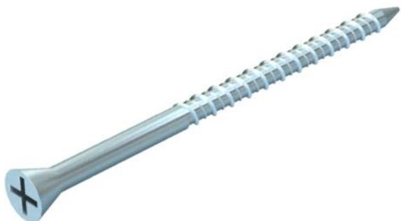
Vis à tête fraisée comme pièce de rechange pour la goulotte coupe-feu PYROLINE® Con, pour la fixation de couvercle, d'embout, d'embase murale et de pièce de doublage d'une épaisseur de plaque de 40 à 60 mm.
