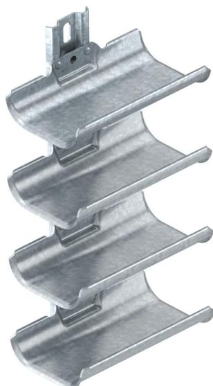
Supporto per cavi per una rapida e semplice posa dei cavi in aree di impiego in cui non possono essere montati sistemi portacavi tradizionali, per ragioni di spazio. Le canaline portacavi dispongono di una grande superficie di posa e di bordi esterni arrotondati per la protezione dei cavi. In conformità con la DIN VDE 0298-300 non si dovrebbe superare una distanza supporto di 0,8 m.
