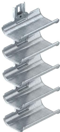
Les gouttières support de câbles sont destinées à une pose simple et rapide dans des zones n'offrant pas un espace suffisant pour montage de systèmes de support de câbles courants. Les gouttières support de câbles dispose d'une grande surface d'appui et de bords extérieurs arrondis pour protéger les câbles. Conformément à la norme DIN VDE 0298-300, ne pas dépasser un écart max. d'appui de 0,8 mm.
