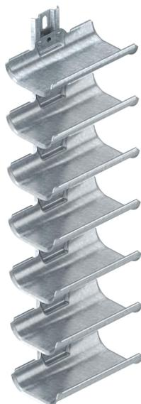
Les gouttières support de câbles sont destinées à une pose simple et rapide dans des zones n'offrant pas un espace suffisant pour montage de systèmes de support de câbles courants. Les gouttières support de câbles dispose d'une grande surface d'appui et de bords extérieurs arrondis pour protéger les câbles. Conformément à la norme DIN VDE 0298-300, ne pas dépasser un écart max. d'appui de 0,8 mm.
