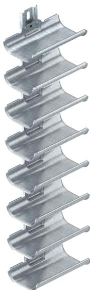
Kabeltragwannen für eine schnelle und einfache Kabelverlegung in Einsatzgebieten, in denen herkömmliche Kabeltragsysteme aus Platzgründen nicht montiert werden können. Die Kabeltragwannen verfügen über eine große Auflagefläche und abgerundete Außenkanten zum Schutz der Kabel. In Anlehnung an die DIN VDE 0298-300 sollte ein max. Stützabstand von 0,8 m nicht überschritten werden.
