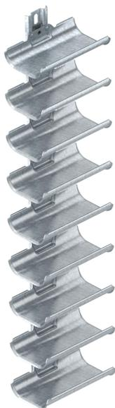
Supporto per cavi per una rapida e semplice posa dei cavi in aree di impiego in cui non possono essere montati sistemi portacavi tradizionali, per ragioni di spazio. Le canaline portacavi dispongono di una grande superficie di posa e di bordi esterni arrotondati per la protezione dei cavi. In conformità con la DIN VDE 0298-300 non si dovrebbe superare una distanza supporto di 0,8 m.
