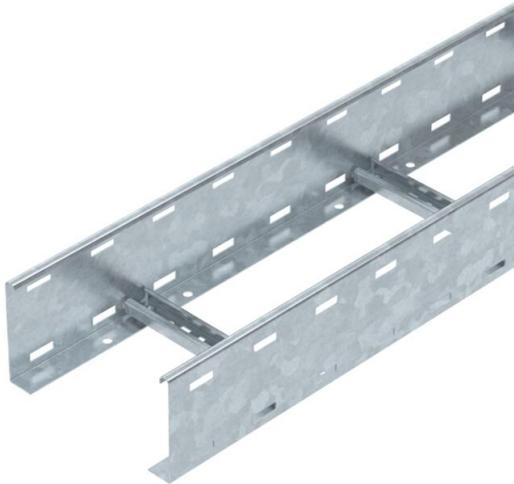
Échelle à câbles d'une hauteur latérale de 110 mm avec échelons soudés à profilé C30 ouvert vers le haut. Longeron latéral enroulé pour le renforcement et la protection des bords. La fixation sur console s'effectue avec des pièces de serrage de type LKS 40. La fente de l'échelon mesure 16,5 mm. La bride de fixation correspondante est de type 2056. Atténuation magnétique du blindage sans couvercle 10 dB, avec couvercle 15 dB.
