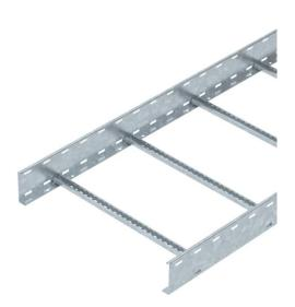
Échelle à câbles d'une hauteur latérale de 110 mm avec échelons soudés à profilé C30 ouvert vers le haut. Longeron latéral enroulé pour le renforcement et la protection des bords. La fixation sur console s'effectue avec des pièces de serrage de type LKS 40. La fente de l'échelon mesure 16,5 mm. La bride de fixation correspondante est de type 2056.
