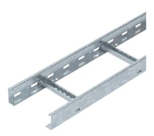
Passerella con bordo di altezza pari a 60 mm, con pioli del profilato C30 aperti verso l'alto saldati. Longherone laterale arrotondato come rinforzo e protezione dei bordi. Il fissaggio alla mensola viene eseguito con morsetti tipo LKS 40. La misura della scanalatura del piolo è pari a 16,5 mm, la staffa reggicavo è il tipo 2056
