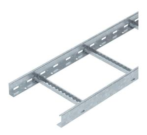
Échelle à câbles d'une hauteur latérale de 60 mm avec échelons soudés à profilé C30 ouvert vers le haut. Longeron latéral enroulé pour le renforcement et la protection des bords. La fixation sur console s'effectue avec des pièces de serrage de type LKS 40. La fente de l'échelon mesure 16,5 mm. La bride de fixation correspondante est de type 2056.
