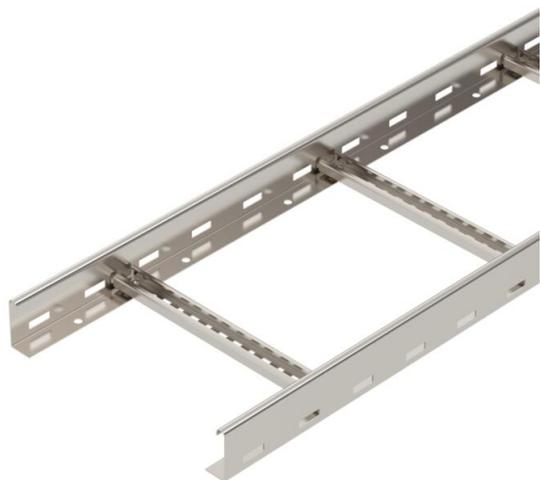
Passerella con bordo di altezza pari a 60 mm saldata, con pioli del profilato a C, larghi 30 mm con scanalatura verso l'alto. Longherone laterale arrotondato come rinforzo e protezione dei bordi. Il fissaggio alla mensola viene eseguito con morsetti tipo LKS 40. La misura della scanalatura del piolo è pari a 16,5 mm, la staffa reggicavo è il tipo 2056. Schermatura elettromagnetica senza coperchio 10 dB, con coperchio 15 dB.
