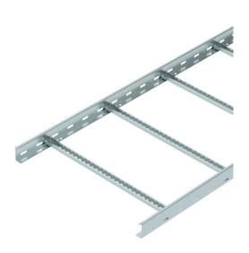
Échelle à câbles d'une hauteur latérale de 60 mm avec échelons soudés à profilé C30 ouvert vers le haut. Longeron latéral enroulé pour le renforcement et la protection des bords. La fixation sur console s'effectue avec des pièces de serrage de type LKS 40. La fente de l'échelon mesure 16,5 mm. La bride de fixation correspondante est de type 2056.
