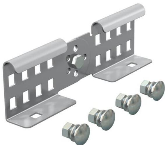
Raccord articulé utilisé à l'extérieur pour l'éclissage d'échelles à câbles et de pièces de forme d'une hauteur latérale de 60 mm et avec perforation constante de longeron.. Angle réglable verticalement
