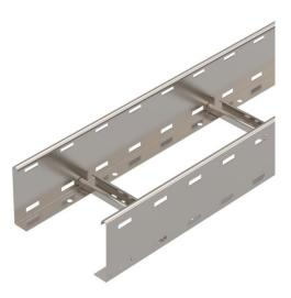
Échelle à câbles avec longeron latéral perforé d'une hauteur latérale de 110 mm, avec échelons rivetés à profilé en C ouvert vers le haut. L'échelle à câbles est livrée repliée.
