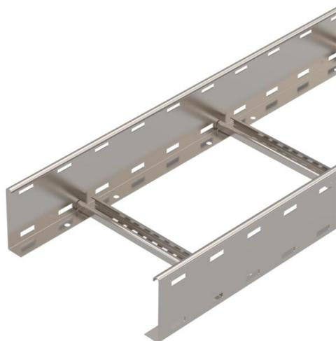
Passerella con longherone forato, con bordo di altezza pari a 110 mm, pioli del profilato a C rivettati e aperti verso l'alto.
