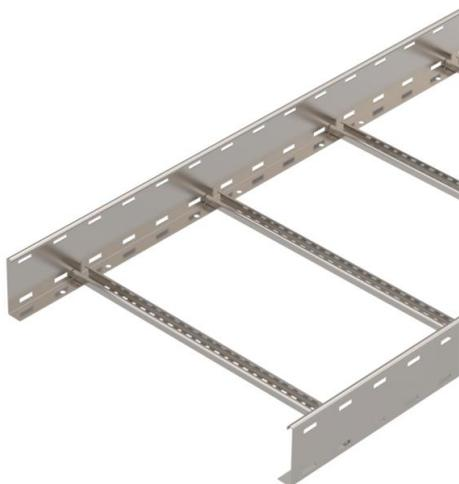
Passerella con longherone forato, con bordo di altezza pari a 110 mm, pioli del profilato a C rivettati e aperti verso l'alto.
