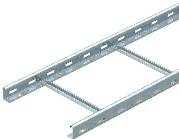
Passerella con longherone forato, con bordo di altezza pari a 45 mm, pioli del profilato a C rivettati e aperti verso l'alto.
