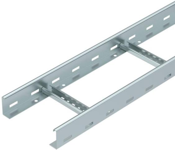
Échelle à câbles avec longeron perforé d'une hauteur de 60 mm, avec échelons VS rivetés (profilé en C) ouverts vers le haut. L'échelle à câbles est livrée repliée.
