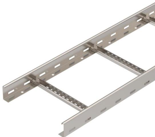
Échelle à câbles avec longeron perforé d'une hauteur de 60 mm, avec échelons VS rivetés (profilé en C) ouverts vers le haut. L'échelle à câbles est livrée repliée.
