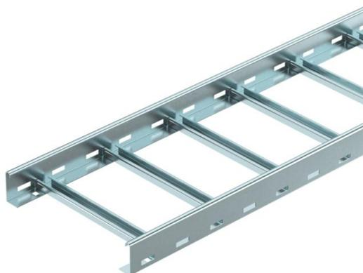
Kabelleiter für die waagerechte Verlegung von Kabeln und Leitungen. In den Breiten 200 - 400 mm einsetzbar als Normtragekonstruktion für den Funktionserhalt nach DIN 4102 Teil 12. Funktionserhaltklassen E30 bis E90. Mit eingienieteter nach oben offener C-Profil-Sprosse.
