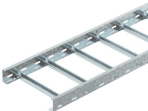
Passerella per la posa orizzontale di cavi. Applicabile nelle larghezze di 200 - 400 mm come costruzione di supporto standard per il mantenimento funzionale secondo DIN 4102 parte 12. Classe di mantenimento funzionale da E30 a E90. Con piolo a C rivettato aperto verso l'alto.
