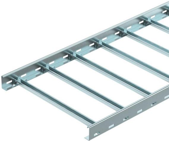
Passerella per la posa orizzontale di cavi. Applicabile nelle larghezze di 200 - 400 mm come costruzione di supporto standard per il mantenimento funzionale secondo DIN 4102 parte 12. Classe di mantenimento funzionale da E30 a E90. Con piolo a C rivettato aperto verso l'alto.
