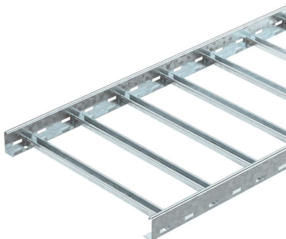
Kabelleiter für die waagerechte Verlegung von Kabeln und Leitungen. In den Breiten 200 - 400 mm einsetzbar als Normtragekonstruktion für den Funktionserhalt nach DIN 4102 Teil 12. Funktionserhaltklassen E30 bis E90. Mit eingienieteter nach oben offener C-Profil-Sprosse.
