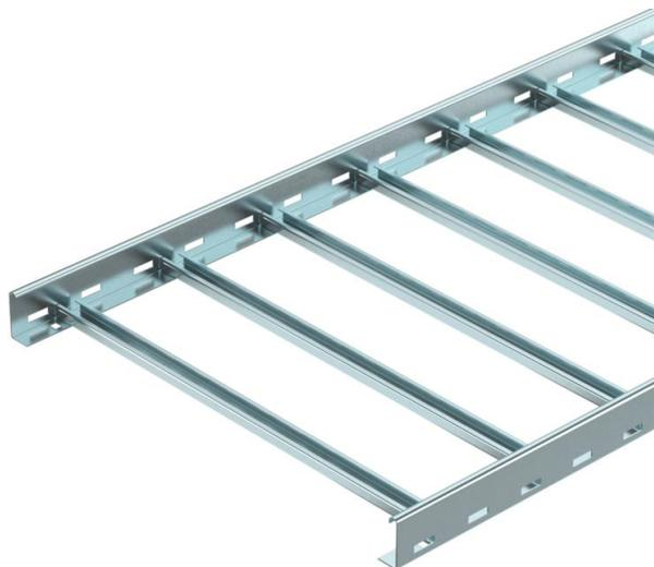
Kabelleiter für die waagerechte Verlegung von Kabeln und Leitungen. In den Breiten 200 - 400 mm einsetzbar als Normtragekonstruktion für den Funktionserhalt nach DIN 4102 Teil 12. Funktionserhaltklassen E30 bis E90. Mit eingienieteter nach oben offener C-Profil-Sprosse.
