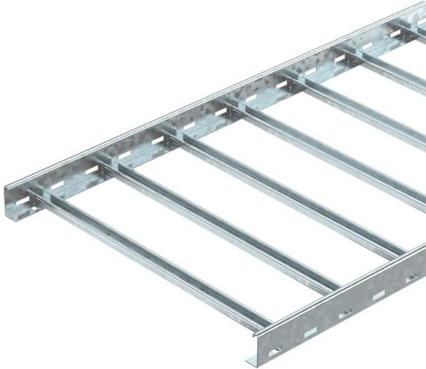
Échelle de câbles pour la pose horizontale de câbles et de conduits. Dans les largeurs 200 - 400 mm, peut être utilisé comme structure porteuse normalisée pour le maintien de la fonction selon DIN 4102 partie 12 Classes de maintien en fonction E30 à E90. Avec un échelon profilé en C riveté et ouvert en haut.
