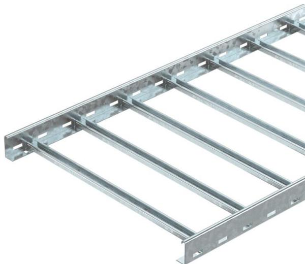
Passerella per la posa orizzontale di cavi. Applicabile nelle larghezze di 200 - 400 mm come costruzione di supporto standard per il mantenimento funzionale secondo DIN 4102 parte 12. Classe di mantenimento funzionale da E30 a E90. Con piolo a C rivettato aperto verso l'alto.
