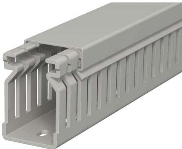
Canale di cablaggio, incl. parte superiore e foratura nel fondo per posa orizzontale e verticale di cavi e linee elettriche nel quadro elettrico. Versione come canale metrico. La misura nominale della grandezza di sistema corrisponde alla misura interna dei canali. La separazione delle linguette avviene senza utensili. Versione a filo possibile tramite punti di rottura predeterminati. Controllato secondo DIN EN 50085-2-3. Lunghezze speciali su richiesta.
