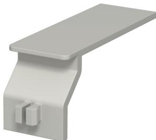
Fermafilo per canali da cablaggio tipo LK4 e LK4 N. Il Fermafilo impedisce la caduta all'esterno delle linee già posate. Il Fermafilo si può ridurre a 38, 28 e 23 mm mediante punti di rottura, per poter essere adattata alle differenti larghezze dei canali.
