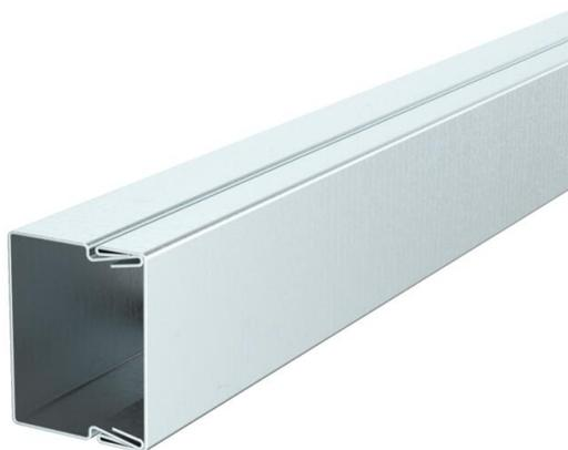
Elemento superiore e inferiore canale con foratura pavimento. Il collegamento equipotenziale tra l'elemento inferiore e superiore viene assicurato senza ulteriori mezzi ausiliari. Il canale guida cavi del tipo LKM 20030 è testato come sistema di posa per mantenimento funzionale conforme a DIN 4102 parte 12. Attenzione ai tipi di cavi testati nell'ambito dei sistemi di protezione antincendio BSS!
