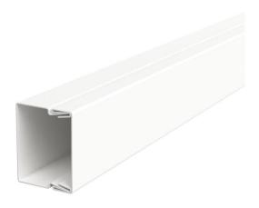
Elemento superiore e inferiore canale con foratura pavimento. Il collegamento equipotenziale tra l'elemento inferiore e superiore viene assicurato senza ulteriori mezzi ausiliari. Il canale guida cavi del tipo LKM 20030 è testato come sistema di posa per mantenimento funzionale conforme a DIN 4102 parte 12. Attenzione ai tipi di cavi testati nell'ambito dei sistemi di protezione antincendio BSS!
