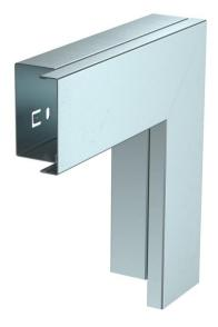
Angle plat avec couvercle pour un changement de direction des goulottes LKM. Liaison équipotentielle assurée sans autre accessoire, entre la partie supérieure et inférieure.
