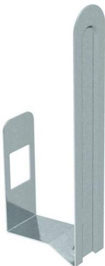
Le clip raidisseur pour goulotte maintient les câbles posés dans la goulotte et facilite ainsi l'installation au mur et au plafond. Les clips raidisseurs pour goulotte sont enfilés dans la lamelle perforée et s'encliquettent dans la paroi latérale. Convient aux largeurs de goulotte de 150 mm et de 200 mm.
