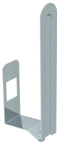
La graffa canale ferma il cavo inserito nel canale, facilitando così l'installazione a parete e a soffitto. Le graffe per canale vengono applicate sul foro passante e agganciate alla parete laterale. Idoneo a larghezza canale di 150 mm e 200 mm.
