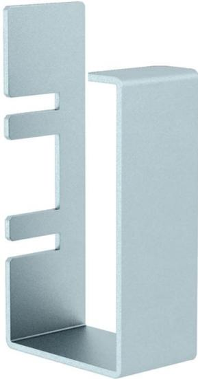
Clip raidisseur pour canal d'installation métallique type LKM 60100, empêche la chute des câbles et conduites pendant l'installation. Le collier de serrage est indispensable lorsque la goulotte est utilisée dans des installations de câbles standards ou de conducteurs pour la sécurité de fonctionnement intégrée selon DIN 4102 partie 12. Montage aisé par introduction dans la lamelle perforée et encliquetage au niveau de la paroi latérale.
