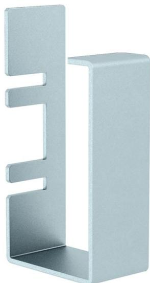
Graffa guida cavi per canale in metallo tipo LKM 60100FS, in grado di impedire la caduta di canali e linee durante l'installazione. La graffa per canale è assolutamente necessaria quando il canale viene montato in impianti di cablaggio con mantenimento funzionale integrato secondo DIN 4102 parte 12. Semplice montaggio tramite inserimento nel foro passante e bloccaggio della parete laterale.
