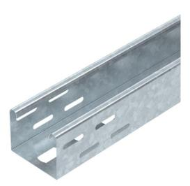
Canal support de luminaires avec fond perforé pour la fixation d'éclairage et le passage de câbles. Le modèle laqué blanc est réservé pour les parties apparentes. Atténuation magnétique du blindage sans couvercle 20 dB, avec couvercle 50 dB.
