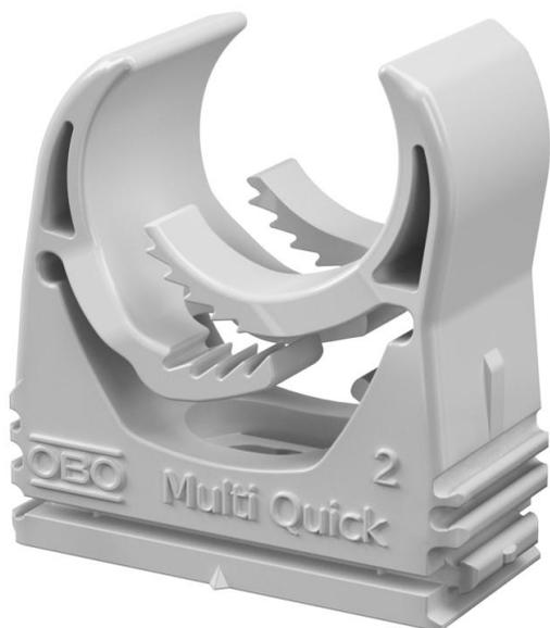
Collier en saillie pour la fixation de tubes métriques, de tubes PG et de tubes d'installations électriques Quick-Pipe. Plage de serrage flexible de plusieurs millimètres. Possibilités de fixation universelles au mur et au plafond, utilisation possible sur rail profilé en intérieur ou dans une zone extérieure protégée. Montage de tubes sans outils. Peuvent être reliés en série, également avec un collier OBO Quick ou starQuick.
