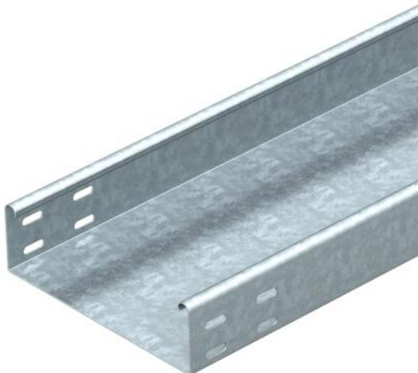
MKSU 60 = sistema di passerelle medio pesante, non forato, con bordo di altezza pari a 60 mm. I giunti lineari devono essere ordinati separatamente. La passerella portacavi è dotata di foratura per giunto su entrambi i lati. Schermatura magnetica senza coperchio 20 dB, con coperchio 50 dB.
