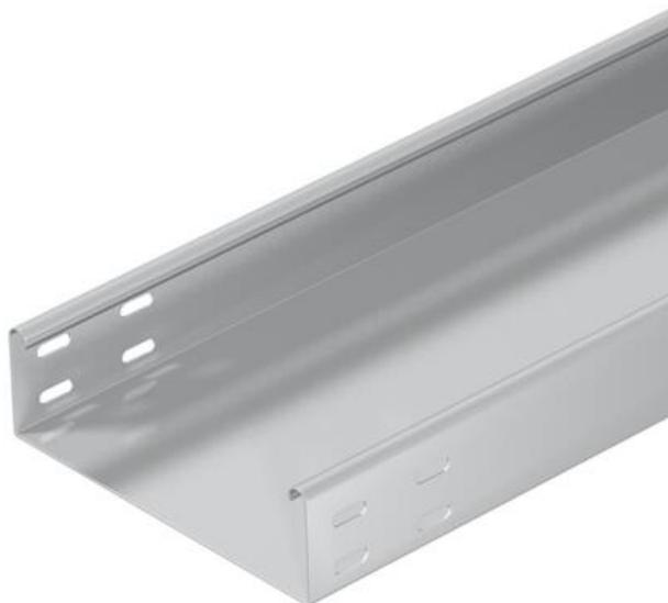
MKSU 60 = système de chemins de câbles non perforé mi-lourd, avec une hauteur latérale de 60 mm.
