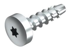
Vis d'ancrage pour le montage direct sans cheville dans de la maçonnerie et du béton fissuré et non fissuré. À tête ronde pour des fixations universelles. Entraînement Torx T30.
