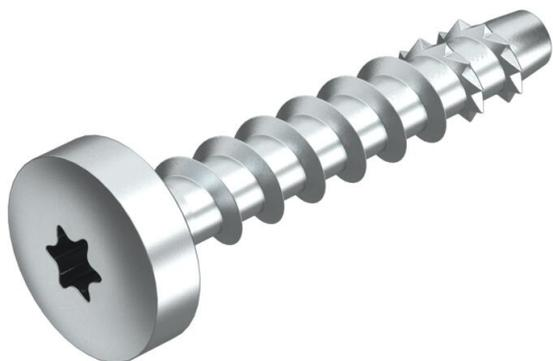
Vis d'ancrage pour le montage direct sans cheville dans de la maçonnerie et du béton fissuré et non fissuré. À tête ronde pour des fixations universelles. Entraînement Torx T30.
