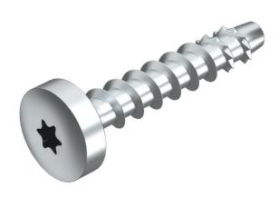
Vis d'ancrage pour le montage direct sans cheville dans de la maçonnerie et du béton fissuré et non fissuré. À tête ronde pour des fixations universelles. Entraînement Torx T30.
