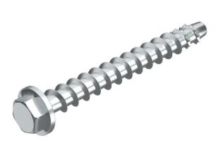
Tirante a vite per il montaggio diretto senza tassello in calcestruzzo fessurato e non fessurato nonché muratura. Con intaglio esagonale e rondella a pressione per grandi carichi. Idoneo per il fissaggio di profilati di sospensione e mensole a parete.
