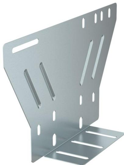
Piastra di montaggio universale per il fissaggio di FireBox serie T sul retro di passerelle portacavi, passerelle grigliate e passerelle a scaletta con altezza laterale max di 60 mm. Permette il montaggio sicuro dei cavi per il mantenimento funzionale senza doverli piegare. Idonea per tutte le FireBox.
