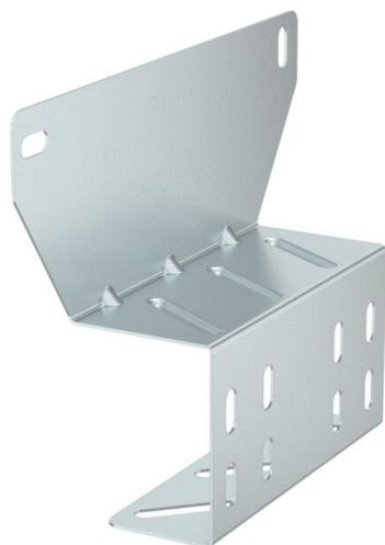
Piastra di montaggio per il fissaggio di scatole di derivazione della Serie T Fire-Box (con fissaggio esterno) a canaline o a passerelle con un'altezza laterale di 60 mm. La forma ad angolo della lamiera in acciaio permette il montaggio del cavo per il mantenimento funzionale senza che il cavo debba essere piegato.
